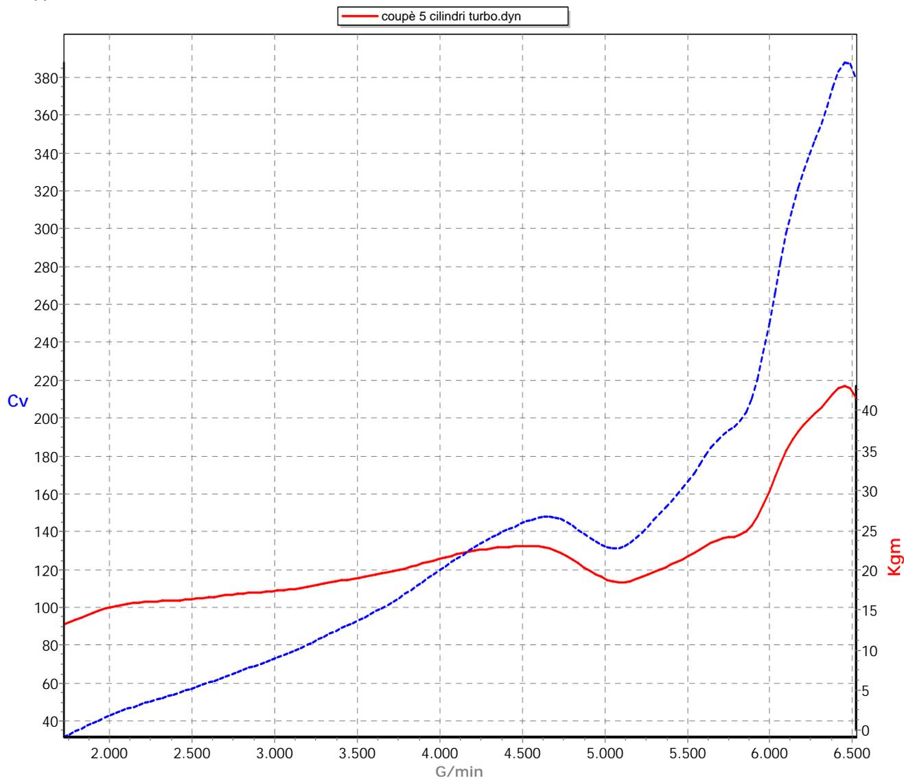
Potenza Motore: 387.7 CV a giri/min: 6450
